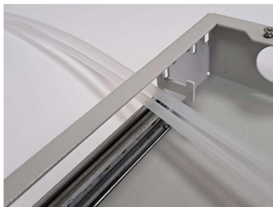
*ENTRARE CON I TUBETTI DI PROTEZIONE DELLE FIBRE NEL SUBTELAIO.*
