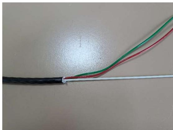
*GESTIRE LA TESTA DI TERMINAZIONE DEL CAVO CON LE MODALITA' PREVISTE DALL'ACCESSORIO UTILIZZATO nell'ODF PER LO SFIOCAMENTO (kit di sfiocamento).*
