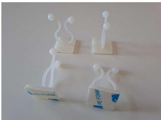
I 4 ANELLI ADESIVI PER LA GUIDA DEI PIGTAILS NON SONO POSIZIONATI. IL LORO POSIZIONAMENTO DIPENDE DALL'INGRESSO DEL CAVO DI RETE DA SINISTRA O DA DESTRA.
