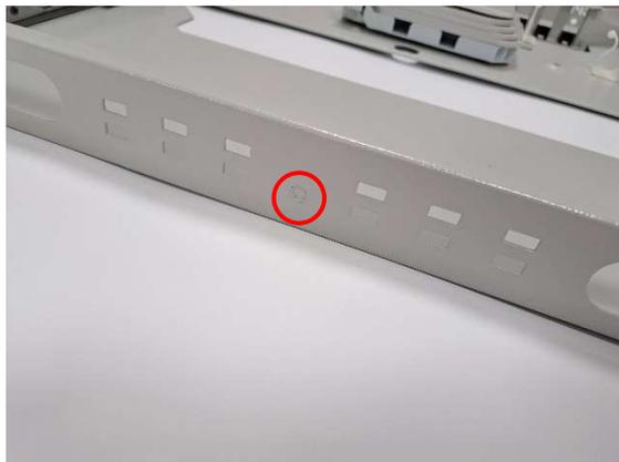
POSIZIONE PER L'ELEMENTO DI FISSAGGIO DEL VTR.
