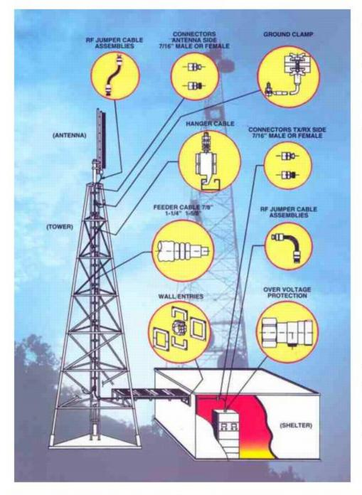
SCHEMATIC EXAMPLE ANTENNA FEEDER CABLE (UP TO 100m) CONNECTOR WALL ENTRIES HANGER CABLE ROOF BUILDING (SHELTER WALL) GROUND CLAMP OVERVOLTAGE PROTECTION CONNECTOR JUMPER CABLE JUMPER CABLE (2 TO 3m) (2 TO 3m) AC SURGE PROTECTOR OVERVOLTAGE PROTECTION BASE STATION
